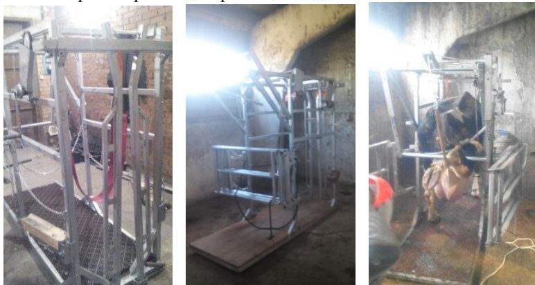
Рисунок 10 – Общий вид станка для обрезки копыт и проведения ветеринарно-санитарных работ проводимых с КРС
