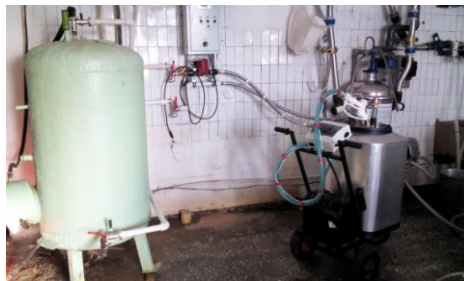
Рисунок 5 – Пастеризация молока в мобильном раздатчике
