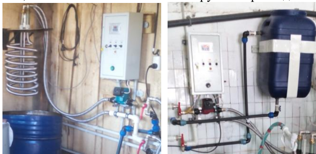
Рисунок 6 – Блок управления процессом пастеризации / нагрева молока
