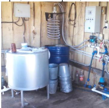
Рисунок 4 – Установка для пастеризации молока на 200 литров
