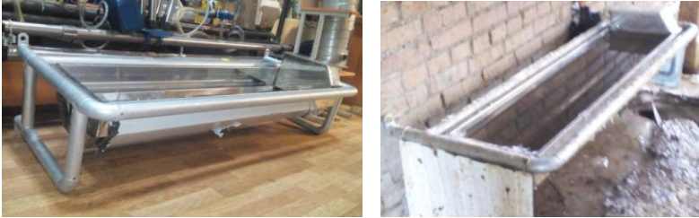
Рисунок 9 – Общий вид групповой поилки с подогревом
