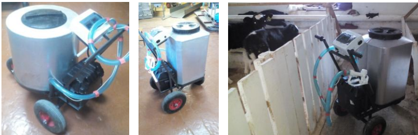
Рисунок 3 – Мобильный раздатчик молока телятам 100 и 90 литров.
